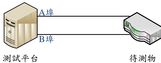
圖 4 吞吐量測試接續圖
