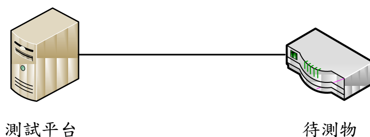
圖 5 阻斷式攻擊測試接續圖
