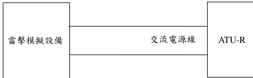
圖十七 AC 電源線雷擊測試架構圖
