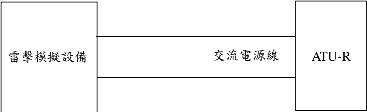
圖十七 AC 電源線雷擊測試架構圖
