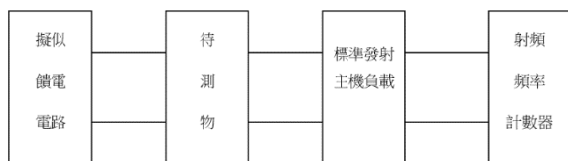
圖二十九 載波頻率測試配置圖
