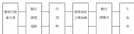
圖三十一 音頻失真測試配置圖
