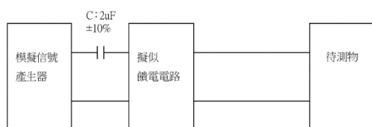
圖四十五 喚醒狀況測試配置圖
