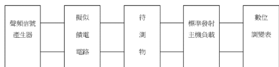
圖三十 調變靈敏度測試配置圖
