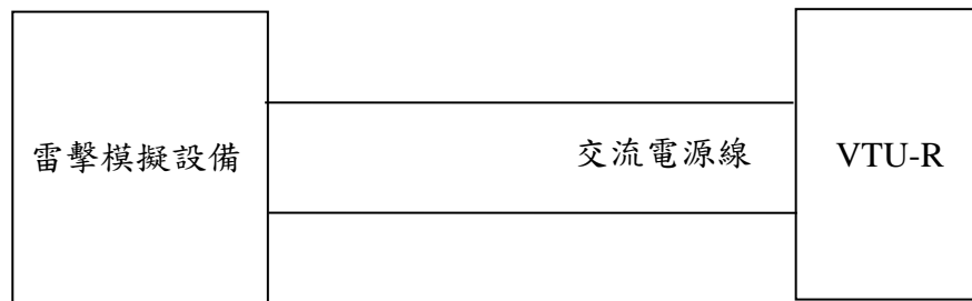
圖十七 交流電源線雷擊測試架構圖
