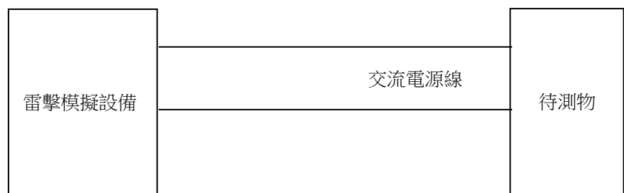
圖二 交流電源線雷擊測試配置圖
